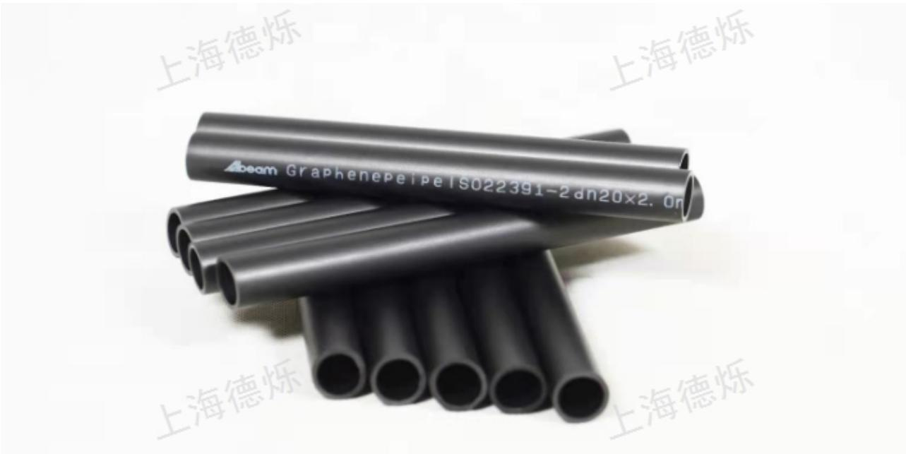
地暖管，当真只是塑料管吗？1、地暖管材都有哪些？答：地暖管从材质上分为以下几种：非交联耐热聚乙烯管[PE-RT]过氧化物交联聚乙烯管[PE-Xa]硅烷交联聚乙烯管[PE-Xb]物理（辐照）交联聚乙烯管[PE-Xc]聚丁烯[PB]交联铝塑复合管[XPAP]这些地暖管材都有什么特质？答：非交联耐热聚乙烯管[PE-RT]：它是一种采用特殊的分子设计和合成工艺生产的一种中密度聚乙烯，它采用乙烯和辛烯共聚的方法通过控制侧链的数量和分布得到的独特的分子接口，来提高PE管的耐热性[PE管的耐热最高温度为60℃]。常用于低温供暖，常见的适用环境为：保温性能较好的高层建筑。聚乙烯[PE-X]此类地暖管占到国内地暖市场的60%。一般所说的PE-Xa[PE-Xb][PE-Xc]是按照生产方式区分的[a和b是化学交联c是更加环保耐用的物理交联方式]a面世早c管晚[a管硬，且不耐高温]c管软，耐高温。整体上PE-X的优点是：耐高温，耐压，易弯曲，施工方便。缺点是不能焊接，必须用金属接头连接。供暖用管：因其良好的保温、施工和长久耐用性，适合用在大厦的连接和地板下采暖管道系统。青海德硕石墨烯地暖管怎么样
